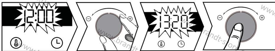
При включении на дисплее мигает 12:00. Установите часы с помощью поворота ручки + и -. Подтвердите установку нажатием на ручку.
