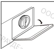
2- Откройте фильтр, повернув его против часовой стрелки.
