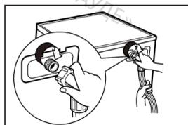
Подсоедините шланг для подачи воды к впускному клапану для воды и крану с холодной водой, как указано.
