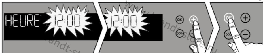
При помощи кнопок «+» и «-» установите текущее время, а затем подтвердите настройку кнопкой **OK**. В случае отключения электричества часы будут мигать. Повторите описанную процедуру настройки.
