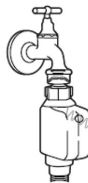
шланг подачи воды с системой безопасности
